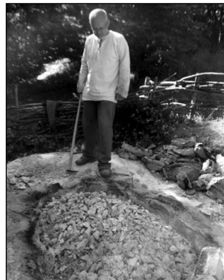
Zahájení vybírání vypáleného vápna z experimentální komorové pece Petrem Kosem.
