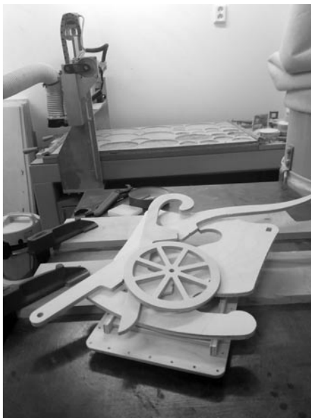
Na fréze vyrábí pan Petr komponenty k pedigu i další zboží na míru.
