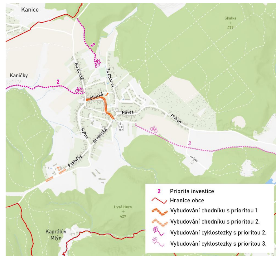
Obr. 11 Schéma zamýšlených chodníků a cyklostezek, Ochoz u Brna
